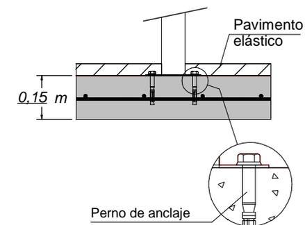
Solera de hormigón HM-20 de 15 cm de espesor en toda la **zona de seguridad**. Colocación de mallazo 20x20 cm ø6 mm y terminación fratasado mecánico.
