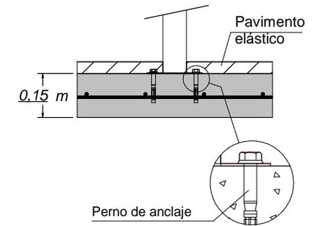
Solera de hormigón HM-20 de 15 cm de espesor en toda la zona de seguridad.
