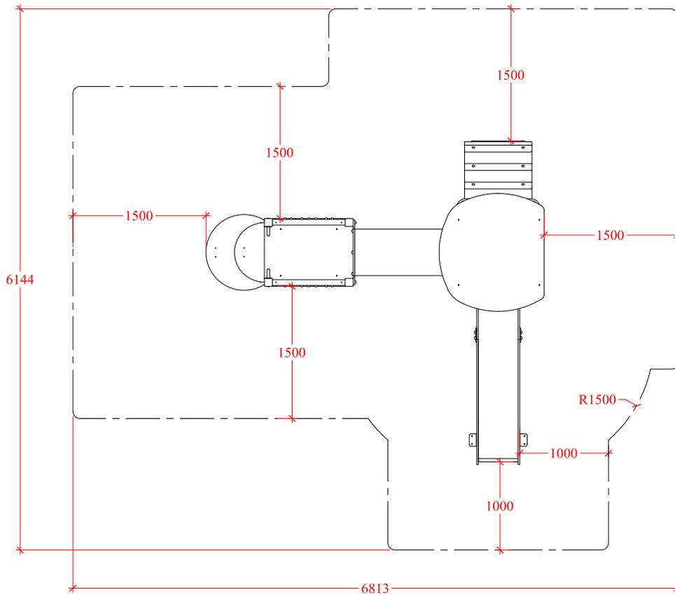
Zona de seguridad válida para pavimento elástico (EN-1176-1), con HIC 1000 para una altura máxima de caída libre de 0,88 m.
