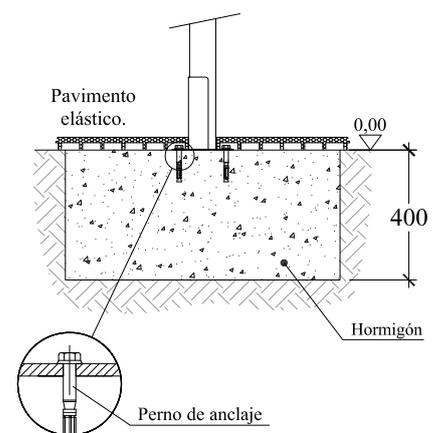
Cimentación válida con pavimento elástico (EN-1176-1).
