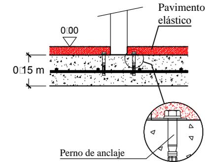
Solera de hormigón HM-20 de 15 cm de espesor en toda la zona de seguridad. Colocación de mallazo 20x20 cm ø6 mm y terminación fratasado mecánico.
