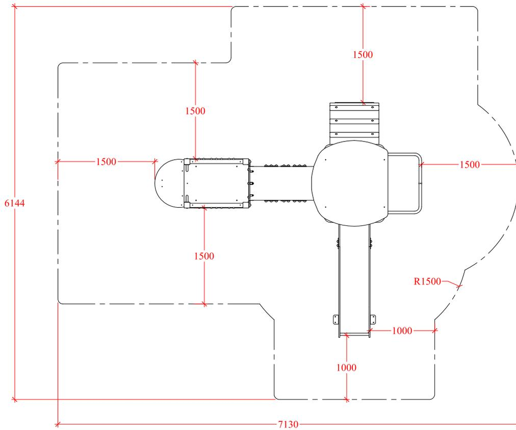
Zona de seguridad válida para pavimento elástico (EN-1176-1), con HIC 1000 para una altura máxima de caída libre de 1,00 m.
