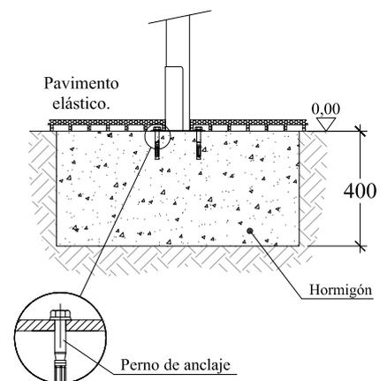
Cimentación válida con pavimento elástico (EN-1176-1).
