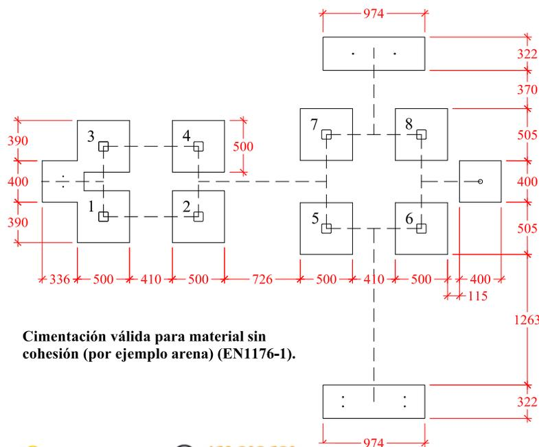
Cimentación válida para material sin cohesión (por ejemplo arena) (EN1176-1).
