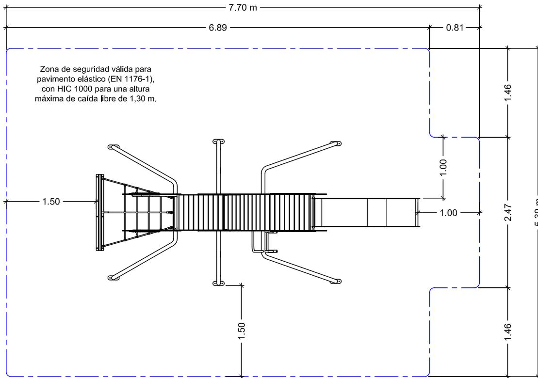
Superficie total de pavimento elástico: 39,12 m<sup>2</sup>.
