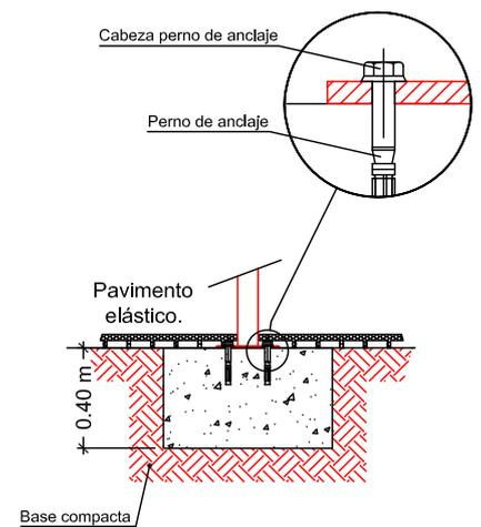
Cimentación válida con pavimento elástico (EN 1176-1).
