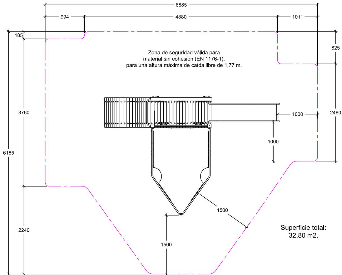
CIMENTACION CON MATERIAL SIN COHESIÓN (POR EJEMPLO ARENA NO COMPACTADA EN TODA LA ZONA DE SEGURIDAD) Y PERNOS DE ANCLAJE
