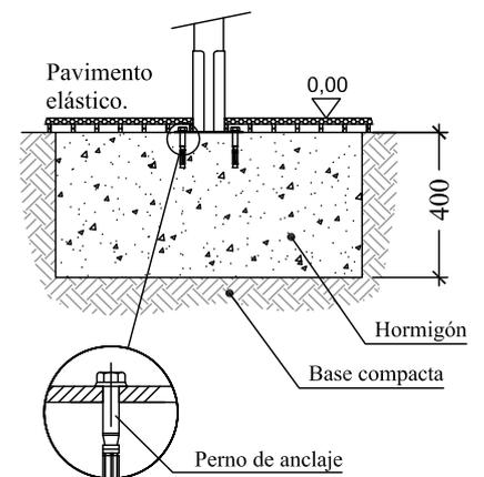
Cimentación válida con pavimento elástico (EN 1176-1).
