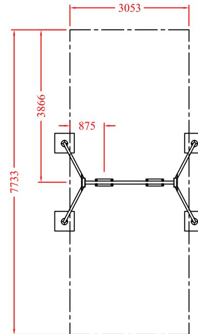
Zona de seguridad válida para material sin cohesión (EN1176-1).
