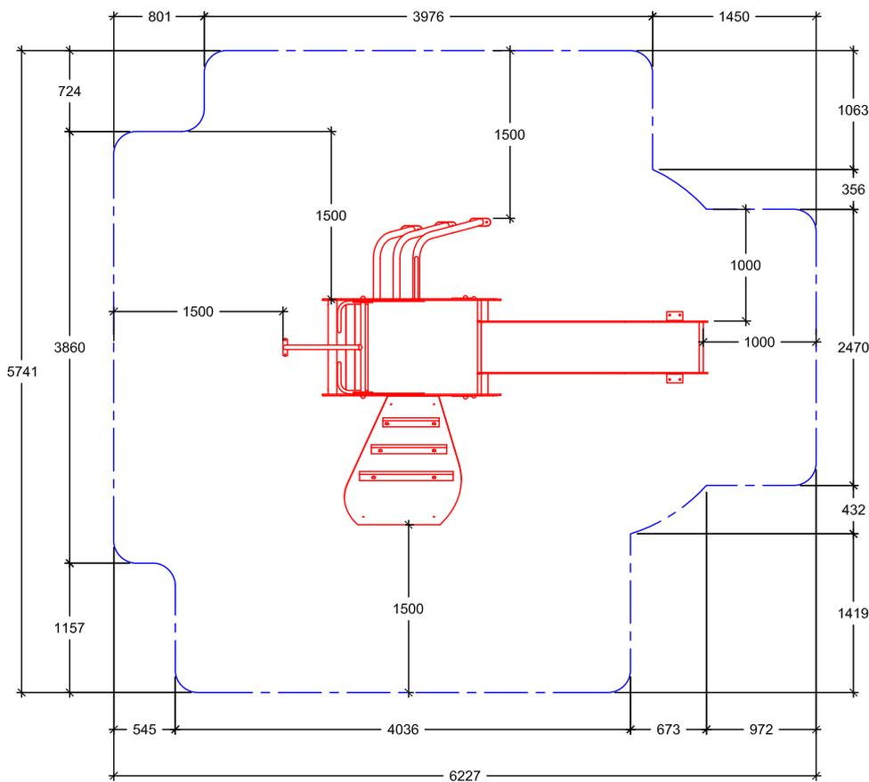
Zona de seguridad válida para pavimento elástico (EN 1176-1), con HIC 1000 para una altura máxima de caída libre de 1,23 m.
