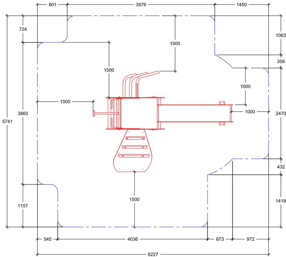
Zona de seguridad válida para material sin cohesión (EN 1176-1), para una altura máxima de caída libre de 1,23 m.
