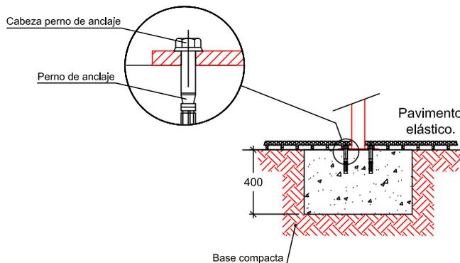
Cimentación válida con pavimento elástico (EN 1176-1).
