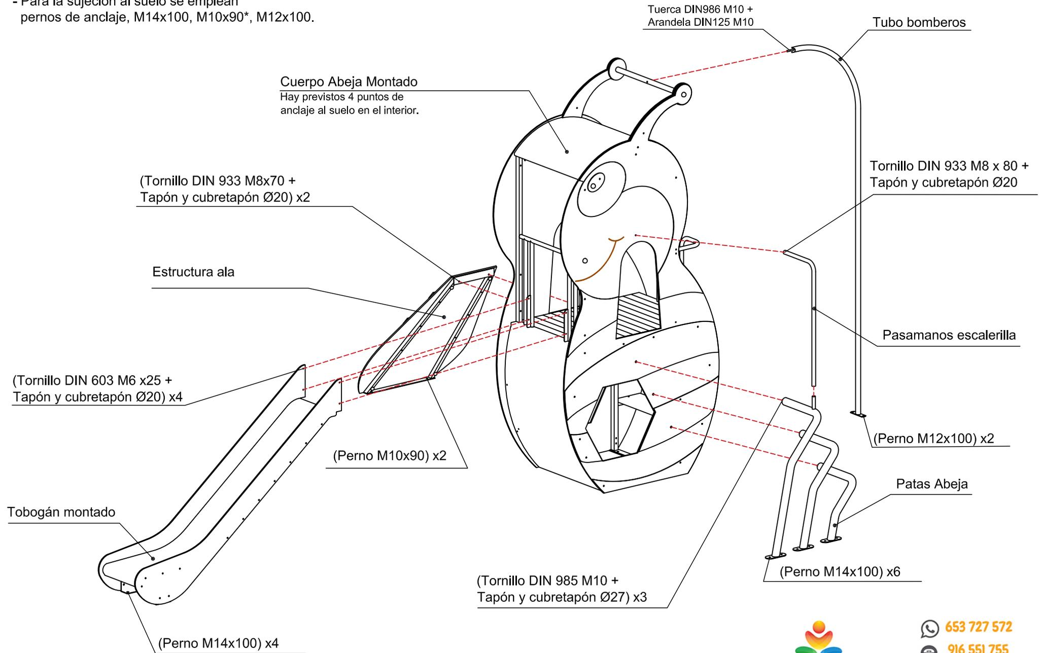
\* Antes de instalar la "Estructura ala" colocar los pernos especiales de M10x90 en el suelo.
